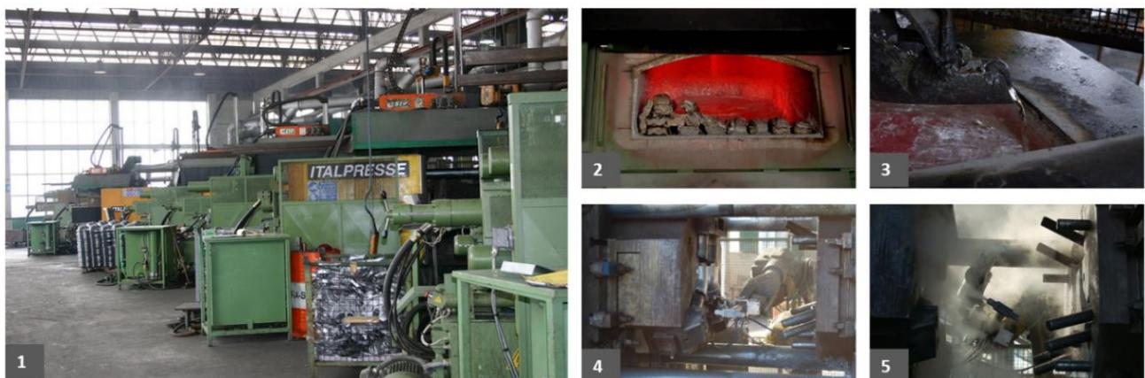
Figura 2. Isola di produzione: 1. Presse in fase di lavorazione, 2. Forno in fase di lavorazione, 3. Caricamento automatico metallo fuso, 4. Robot antropomorfo per il prelievo di pezzo, 5. Fase di lubrificazione dello stampo
